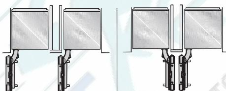
Промежуточная стенка может быть толщиной мин. 16 мм.
