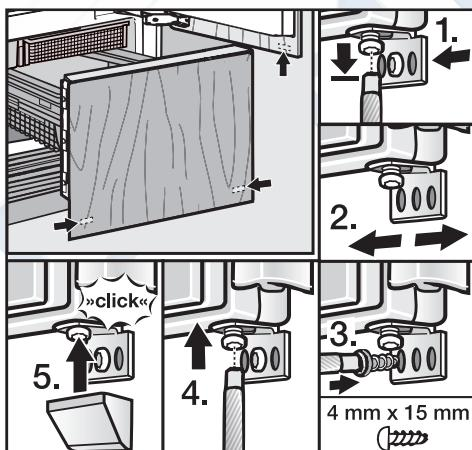
С помощью крепежных уголков мебельные фронты крепятся снизу к дверям прибора.
